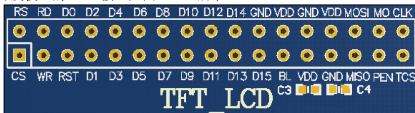
图 25.2.1 TFTLCD 模块与开发板对接的 LCD 接口示意图
