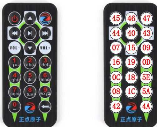
图 40.3.2.1 红外遥控器按键对应的控制码图（十六进制数）
