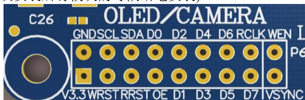
图 46.2.1 开发板上连接 OV7725 模块的座子
