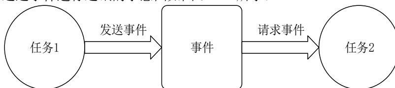
图 64.1.1 两个任务使用事件进行通信的示意图
