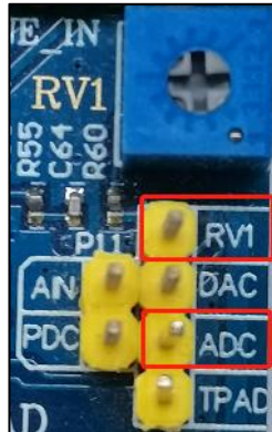
图 30.3.2.1 PA1（对应 ADC 排针）与电位器示意图
