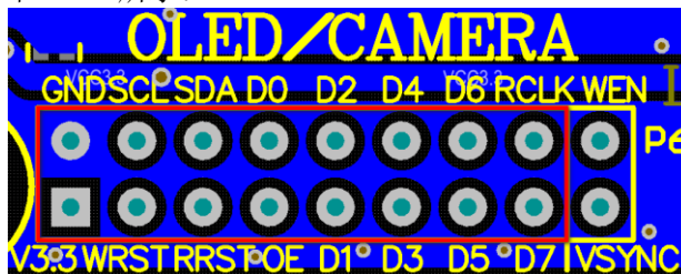
图 24.2.1 OLED 模块与开发板连接示意图
