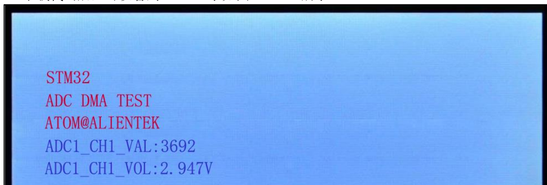
图 30.3.4.1 单通道 ADC 采集（DMA 读取）实验测试图
