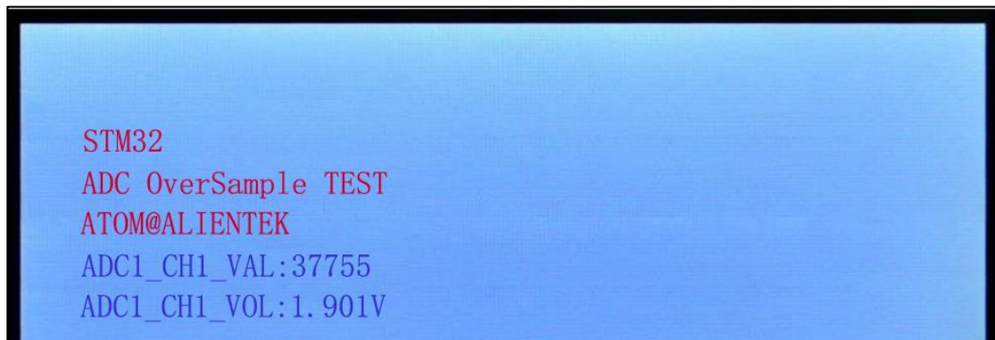
图 30.5.4.1 单通道 ADC 过采样（16 位分辨率）实验测试图
