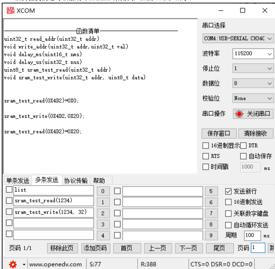
图 47.5.3 借助 USART 测试外部 SRAM 读写
