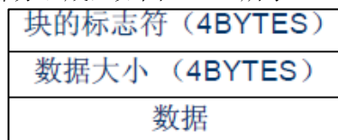
图 55.1.1 Chunk 结构示意图
