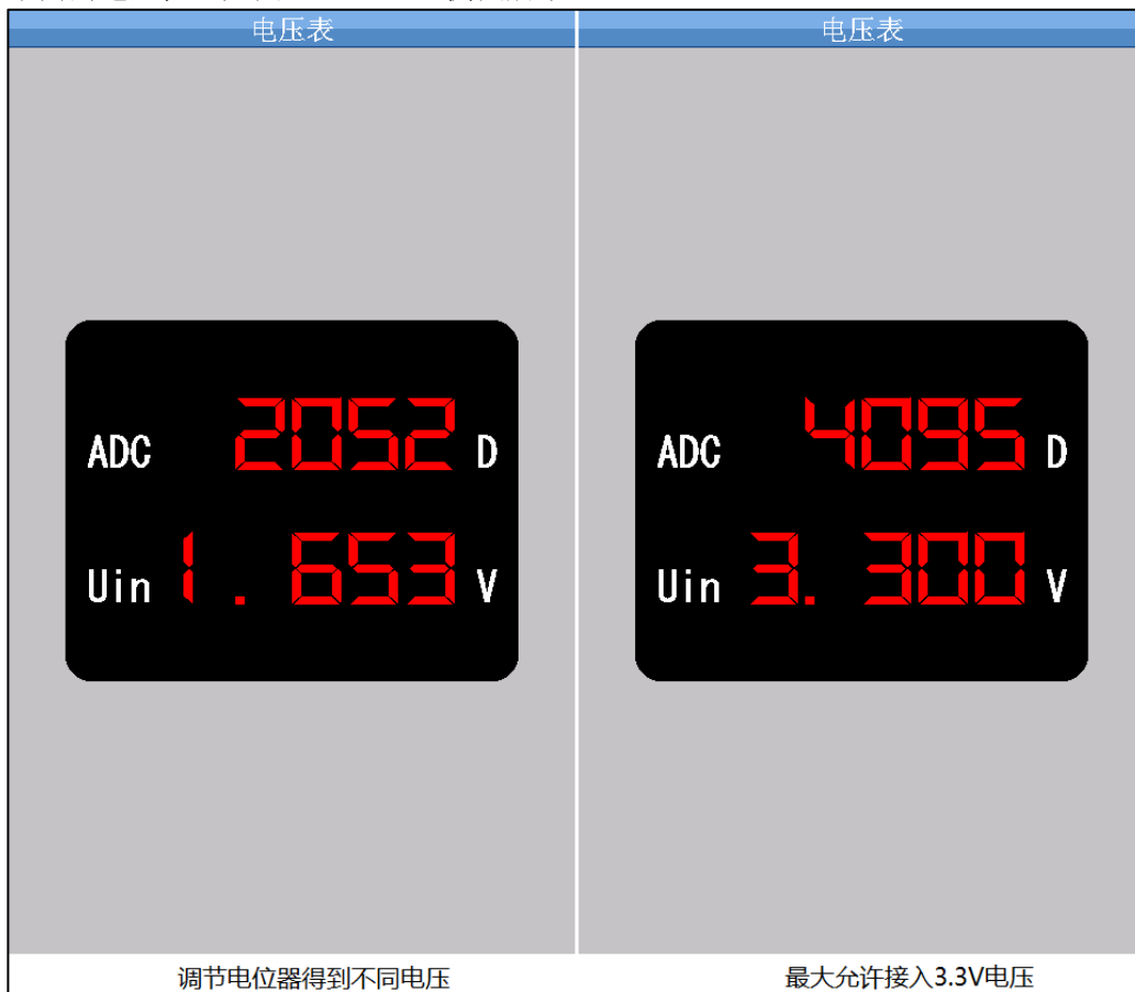
图 66.2.19.2 调节电位器得到不同电压和最大允许接入 3.3V 电压
