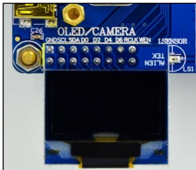
图 24.2.2 OLED 模块与开发板连接实物图
