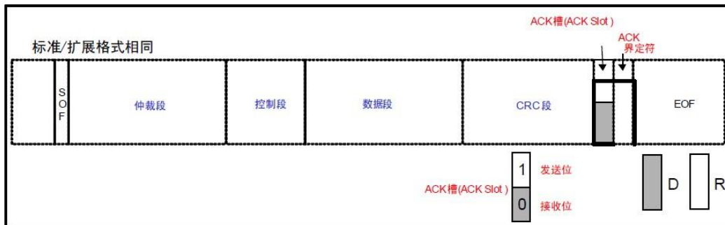
图 38.1.2.6 数据帧 ACK 段构成
