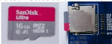
图 49.5.1 测试用的 microSD 卡与开发板的连接方式 SD 卡成功初始化后，LCD 显示本程序的一些必要信息，如图 49.5.2 所示：
