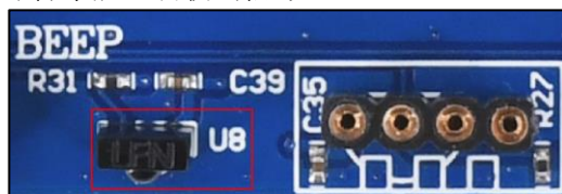
图 40.2.3 开发板上的红外接收管位置
